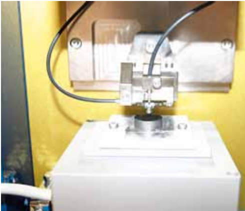
Abb. 4: Testaufbau Kugel-Platte am Mikrolast-Tribometer (Falex Must Micro Tribometer)
