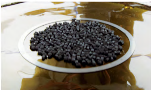
Abb. 7: Erzeugung einer Folie aus Polyamid 6.6-Granulat
