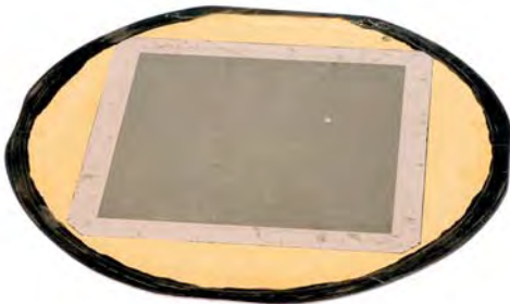
Abb. 1: Beispiel eines aus Nickel gefertigten Shim-Formeinsatzes ( \varnothing ~90 mm, Dicke ~500 \mu\text{m} )
